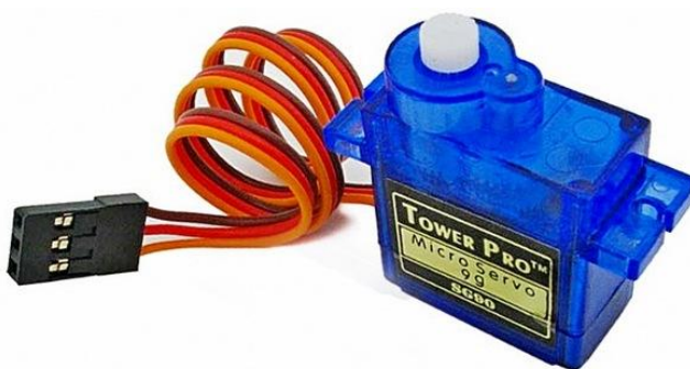
Рисунок 3.1 – Сервопривод для изменение положение камеры
