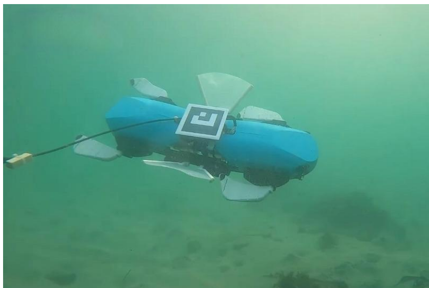
Рисунок 1.6 – Передвижение подводного робота с помощью искусственных ласт
