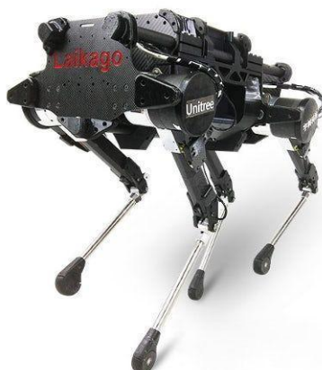
Рисунок 1.4 – Шагающий способ передвижения на примере робота Laikago
