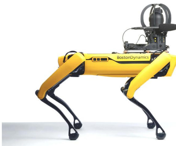
Рисунок 1.7 Spot, мобильный робот с возможностью адаптации через SDK.
